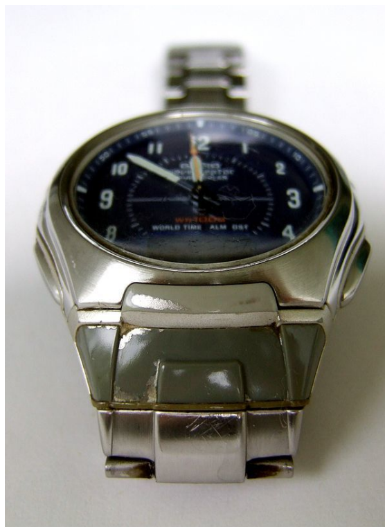
État de l'abrasion de la couleur argentée de la patte en plastique d'un bracelet en acier inoxydable d'une montre, dans la troisième année de son utilisation normale.
